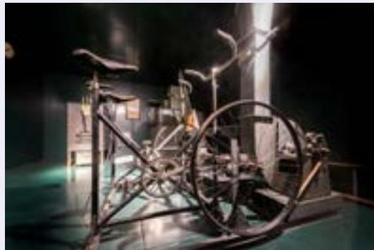
Un cyclo-pédaleur installé dans l'abri permettait d'alimenter les lieux en électricité ou en air filtré © Pierre Antoine
